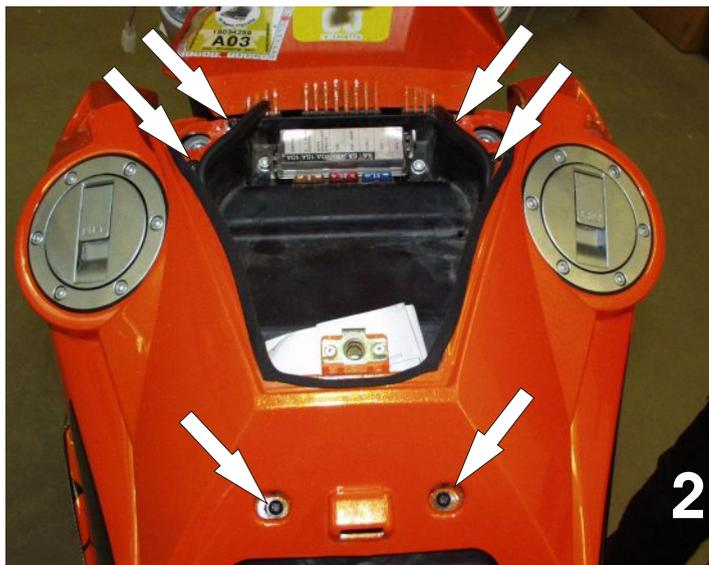
Die Benzinhähne beider Tankhälften schließen und die Verschraubungen der rechten Tankhälfte lösen. Tankhälfte abnehmen und Schläuche abziehen.
